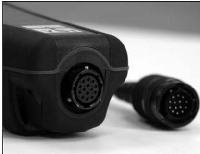
Abbildung 4, Auf die Schlitze im Kabelanschluss achten.
