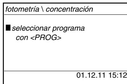
Con <M> se alterna entre los diferentes parámetros *concentración*, *extinción* y *% transmisión*.
