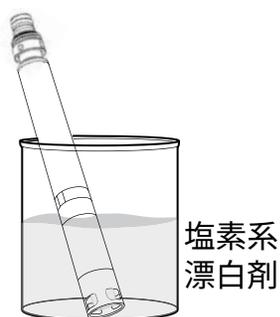
図74 塩素系漂白剤を使用した pH および pH/ORP センサーの清掃
