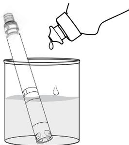
図72 食器用洗剤を使用した pH および pH/ORP センサーの清掃
