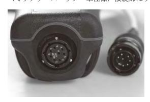
図 6. キーコネクタ部。 ケーブルと機器本体コネクターはキー区分が一箇所のみ正しく整列している。 接続がされていない場合、ケーブルコネクタ部と機器コネクタ部は IP67 防水規格です。
