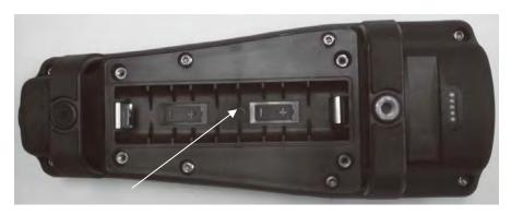
画 1 バッテリーカバーをはずした Pro ODO。 バッテリー極表示が正しい電池向き示します。
