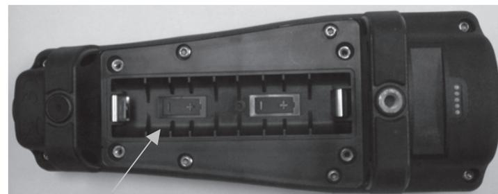
Figura 1. ProODO con il coperchio del vano delle batterie rimosso. Notare i simboli delle batterie che indicano la polarità.
