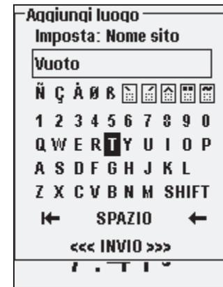
Le schermate numeriche visualizzano solo numeri (schermata in alto a sinistra). Le schermate alfanumeriche visualizzano numeri nella parte superiore e lettere nella parte inferiore (schermata in alto a destra). Le lettere appaiono nella comune disposizione a tastiera.
