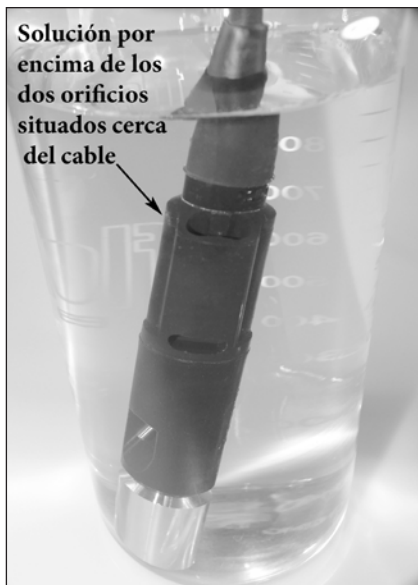
Figura 7. Solución por encima de los dos orificios situados cerca del cable.
