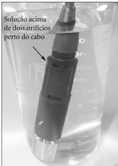
Figura 7, Solução acima de dois orifícios perto do cabo.
