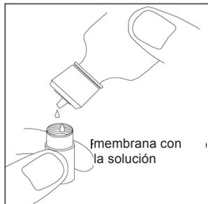
Llene  $\frac{3}{4}$  una nueva membrana de la tapa con solución electrolítica que se haya preparado conforme a las instrucciones de la botella. Tenga mucho cuidado de no tocar la superficie de la membrana.
