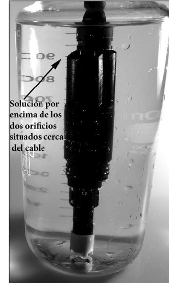
Figura 8. Solución por encima de los dos orificios situados cerca del cable.
