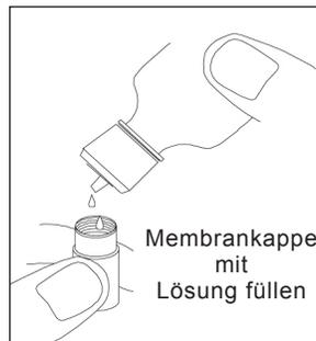
Füllen Sie eine neue Kappenmembran 3/4 voll mit Elektrolytlösung, die entsprechend dem Etikett auf der Flasche vorbereitet worden ist. Achten Sie sorgfältig darauf, dass Sie die Membranoberfläche nicht berühren.
