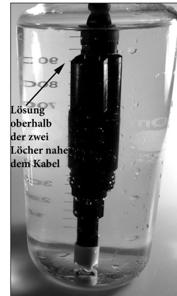
Abbildung 8. Lösung oberhalb der zwei Löcher nahe dem Kabel.
