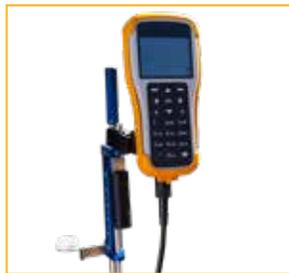
La perche de mesure de débit de SonTek, dotée d'une poignée robuste et d'un niveau à bulle.
